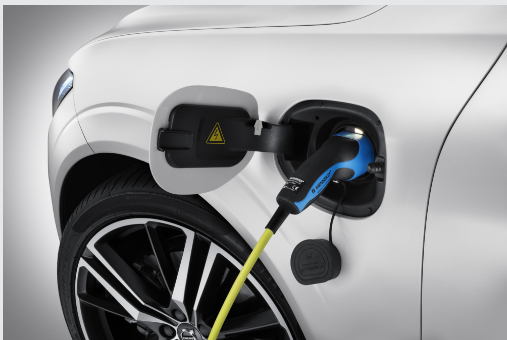
Zásuvka na nabíjanie batérie na ľavom prednom blatníku
